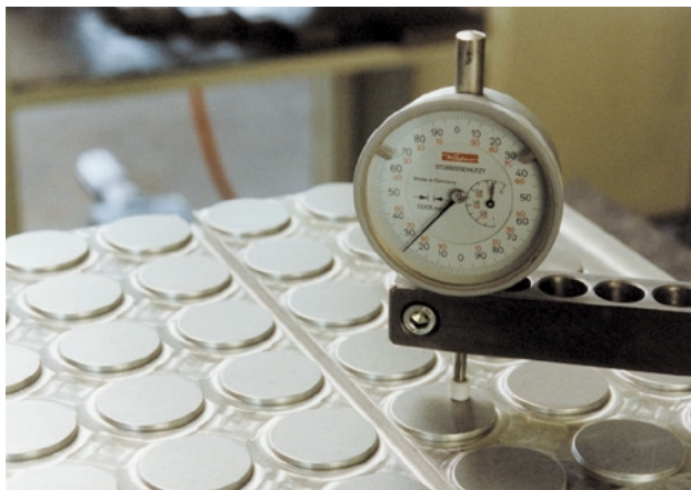
Qualitätsprüfung eines Gussheizkörpers für die Verpackungsindustrie Quality control of a Cast Heater for the packaging industry
